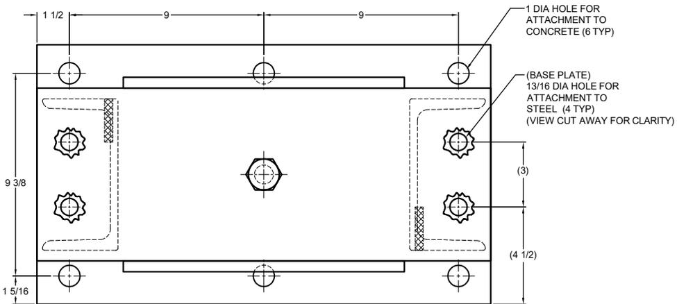
**MODEL M2SS-3E SEISMICALLY RESTRAINED VIBRATION ISOLATOR FOR 3" DEFLECTION**
